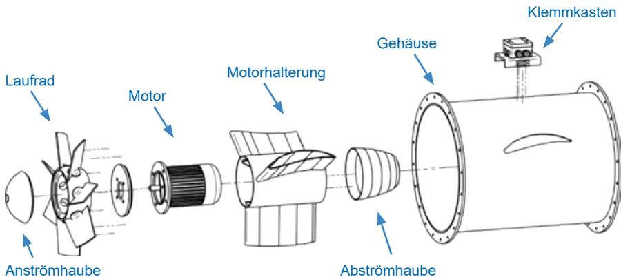
Abb. 1a| Übersicht des Ventilators HF A ..... D
