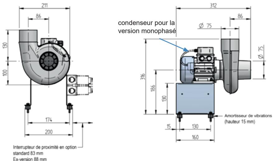
Fig. 1a| Châssis version avec moteur à courant triphasé ou courant monophasé
