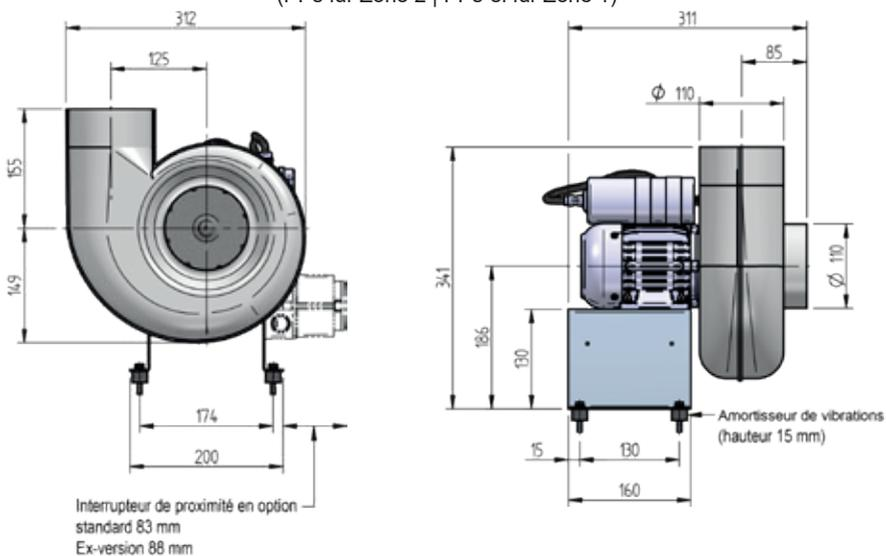
Fig. 1f| Châssis version avec ex-moteur à courant triphasé ou courant monophasé
