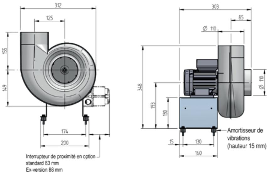
Fig. 1e| Châssis version avec ex-moteur à courant triphasé ou courant monophasé
