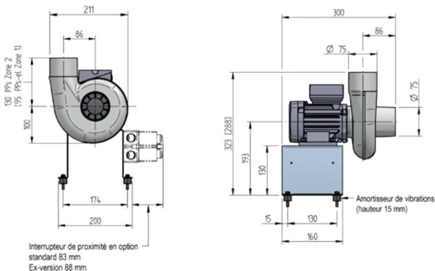
Fig. 1b| Châssis version avec ex-moteur à courant triphasé ou courant monophasé
