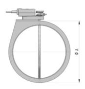
Absperrklappe mit Handverstellung (bis Ø 400 einseitig ab Ø 450 beidseitig)
