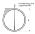
Absperrklappe mit aufgebautem Klappenstellantrieb (Ausführung elektrisch oder pneumatisch)
