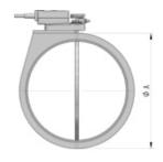
Absperrklappe mit Handverstellung (bis Ø 400 einseitig ab Ø 450 beidseitig)
