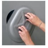
Die Sterngriffe bis zum Anschlag der gelben Schutzkappe losdrehen. Anschließend den Deckel unter leichtem Verdrehen in die Öffnung einschieben.
